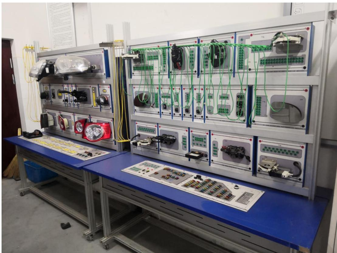
图 13 汽车电控实训台架
